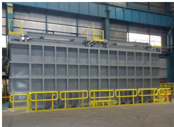
Neuer Tiefofen 21/22 (Inbetriebnahme 2023)
