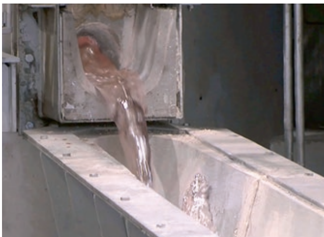
Flüssiges Aluminium fließt wie Wasser
