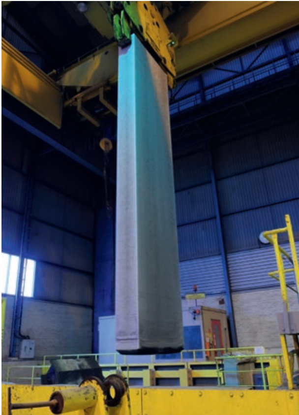
Gegossener Barren – ca. 9 m lang
