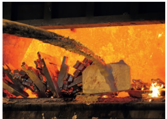
Schmelzofen – Einsatz von Masseln
