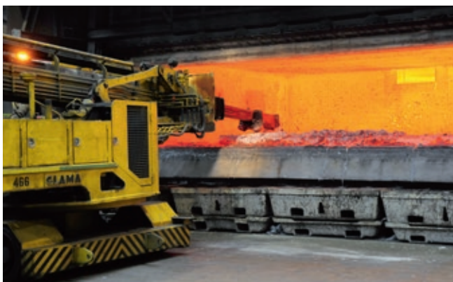
Kratze abziehen im Schmelzprozess
